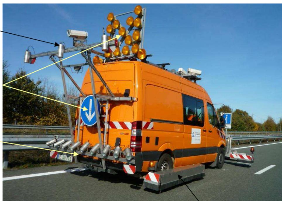
Poutre laser de mesure de l'uni longitudinal
