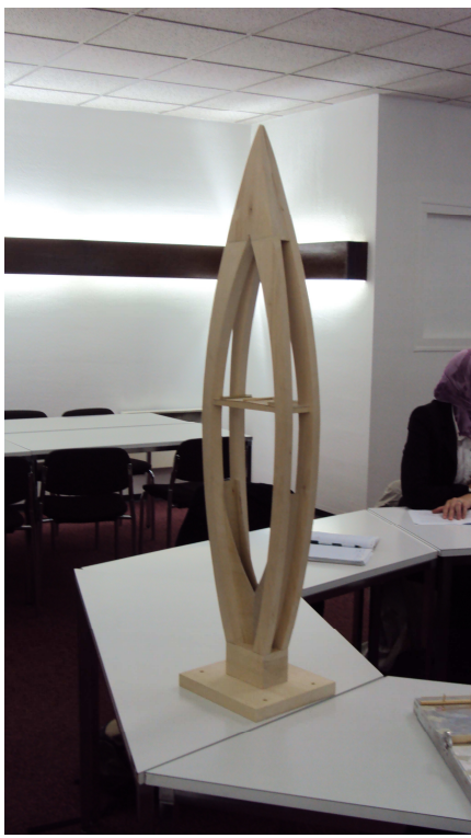
Figure 27 : La maquette d'un pylône devant servir aux essais dynamiques.
