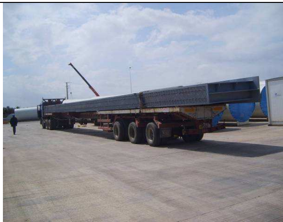
Figure 33- Chargement des poutres sur des camions télescopiques
