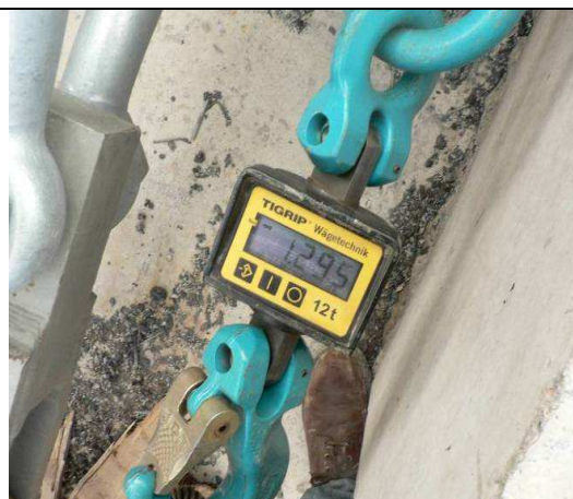
Figure 49 - Peson indiquant l'effort de traction
