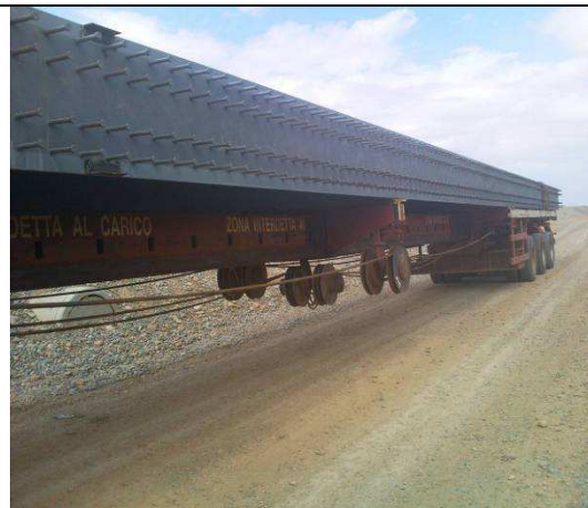
Figure 33- Chargement des poutres sur des camions télescopiques
