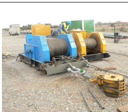
Figure 45 - Treuils de retenue (bleu) et de tirage (jaune)
