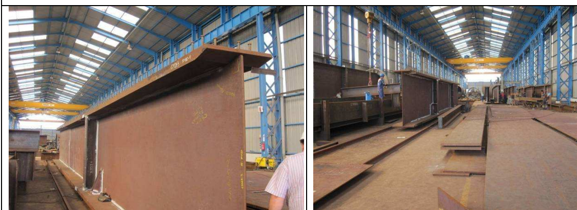
Figure 31 - Poutres finies et contrôlées en attente d'être peintes
