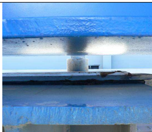
Figure 56 - Complexe de glissement sur plot : caoutchouc+tôle+PTFE
