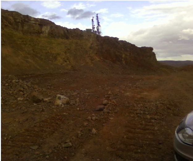
Stratigraphie du rocher avec présence de poche de marne.
