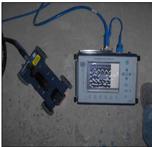
Ph 1 : Radar pour détection des aciers
