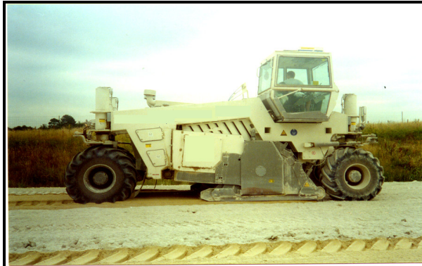
Photo 2 : Pulvimixeur malaxant jusqu'à 40 cm
