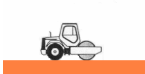
Phase 4 : Compactage de la plateforme
