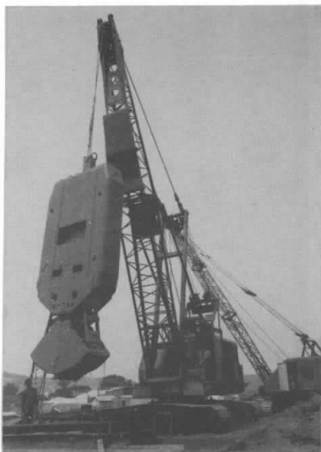
Benne lourde à câble, type KL, pour l'exécution de barrettes ou de parois moulées. Noter l'importance de la jupe de guidage. (Document Cie Marocaine SIF)
