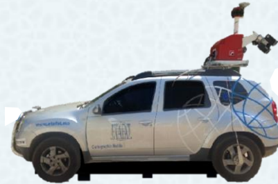
Scanner Laser 3D embarqué sur véhicule
