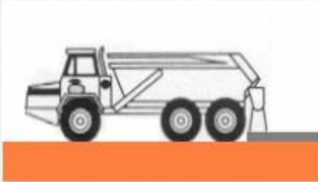
1 – Epandage de la chaux
