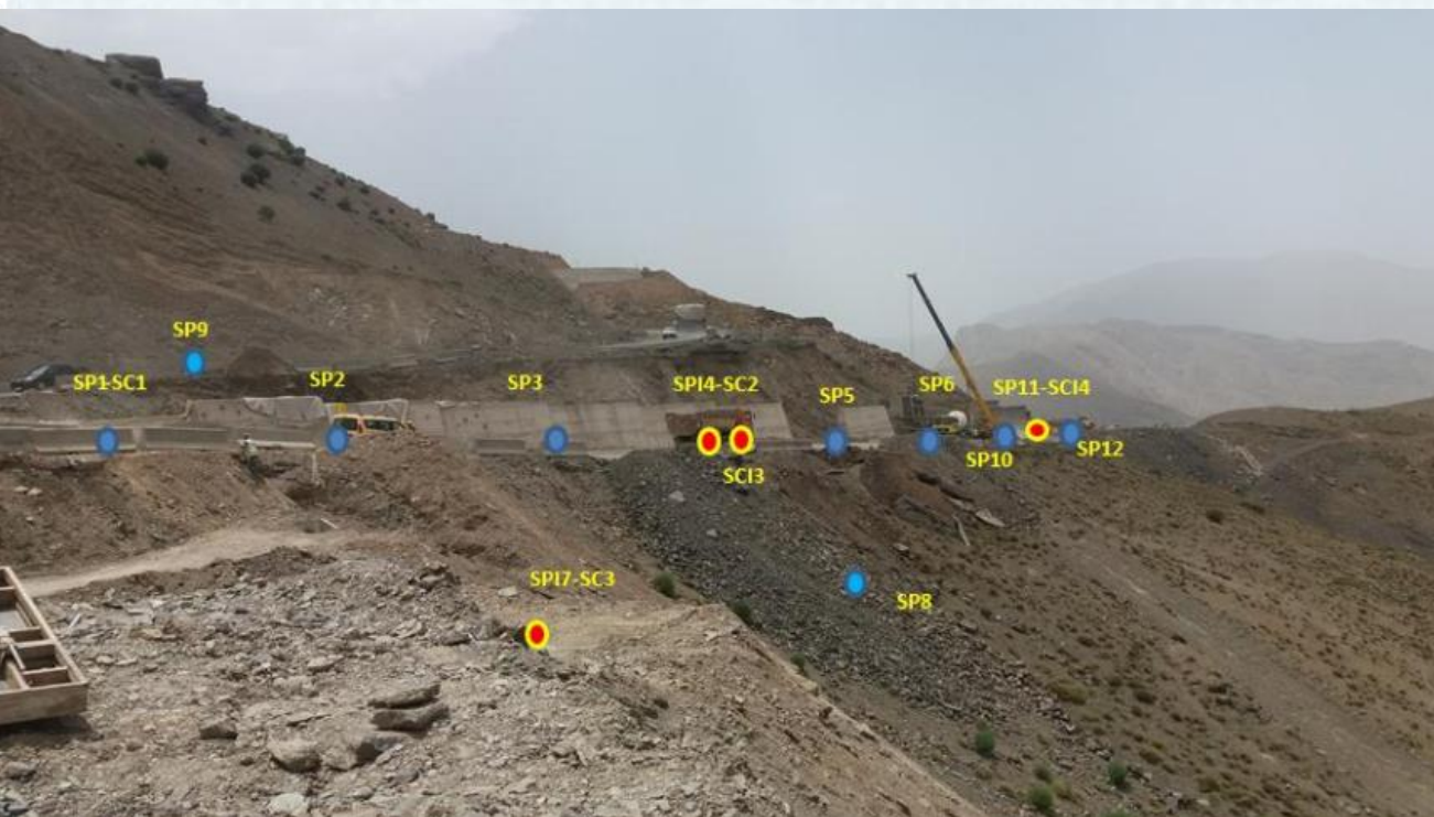
Plan d'implantation des sondages – zone 5
