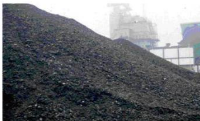
Fig. n°6 : Agrégats d'enrobé après constitution d'un lot obtenu par concassage et criblage
