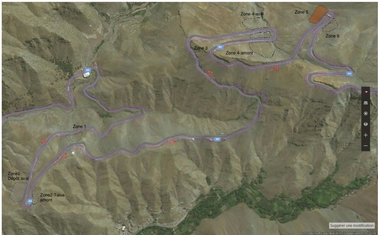
Figure 2 : zones d'instabilité sur le tronçon 1 de la RN9 entre Taddart2 et le col Tizi N'Tichka (sens de montée en rouge)
