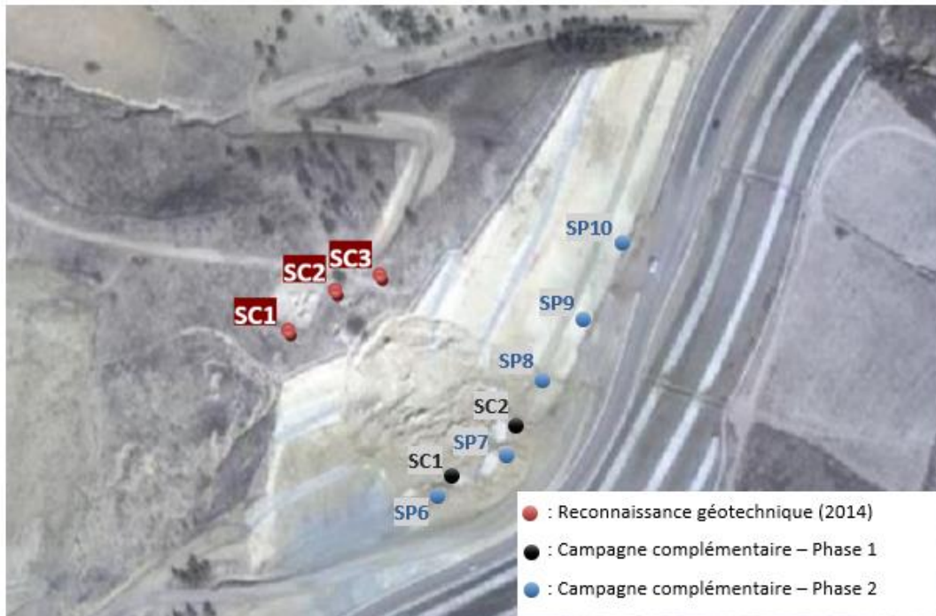
Figure 7 : Implantation des sondages de reconnaissance géotechnique
